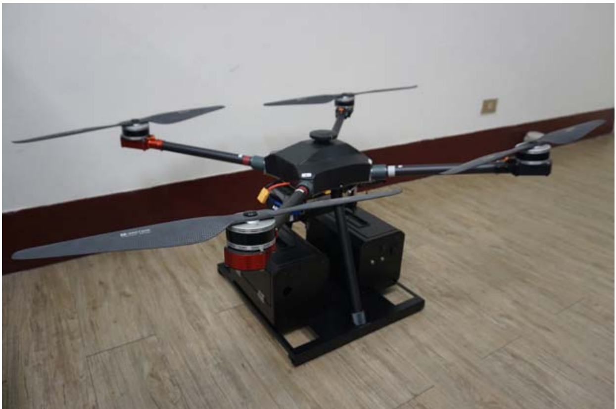
裝載於空拍機後的光學式空氣品質偵測系統(空拍機長 123cm，寬 40cm，高 47cm，重量 4kg，可載重 2kg)
