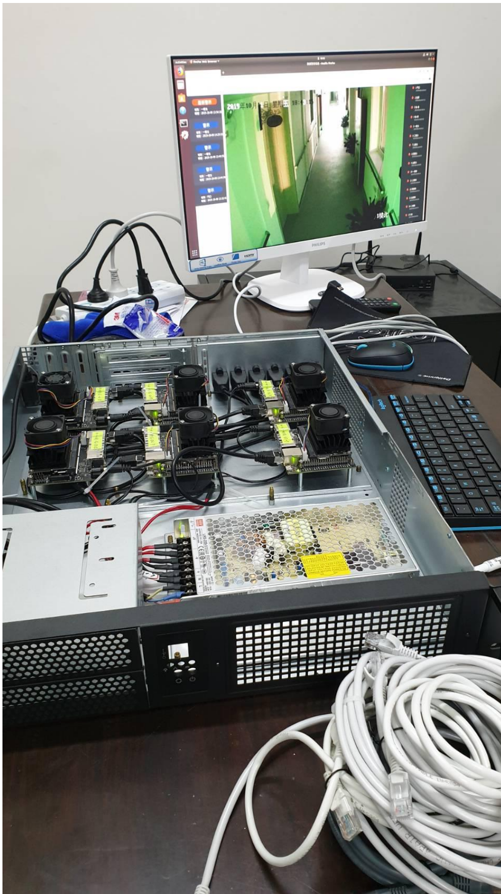
中國大陸西安養老院架設「AI 影像感測器」系統。監控畫面(圖上)、AI 跌倒影像邊緣運算伺服器(圖下)
