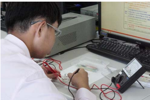
用三用電表量測電壓值
