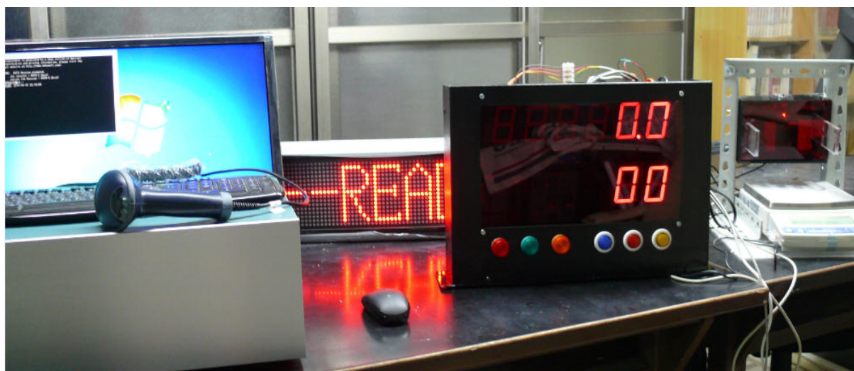
照片 1：「配藥 SOP 系統」包括主控器、磅秤控制器、秤桶辨識器與精密天平
